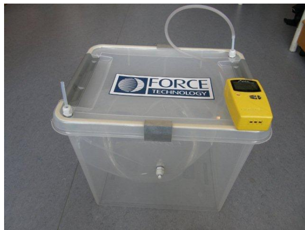
Lugtprøvetagning med pumpe og pose i plastkasse
