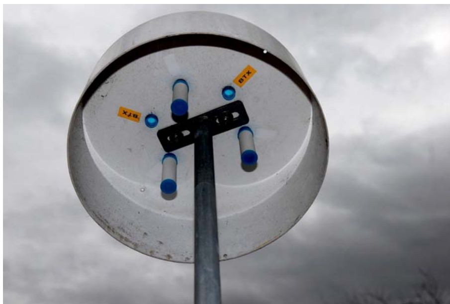
Figur 3.8. De tre passive opsamlere (Radiellorør) er placeret inde under bunden af den hvide plastikspand. De er derfor beskyttet mod regn og kraftig vind samtidigt med, at de er frit eksponeret for den omgivende luft.
