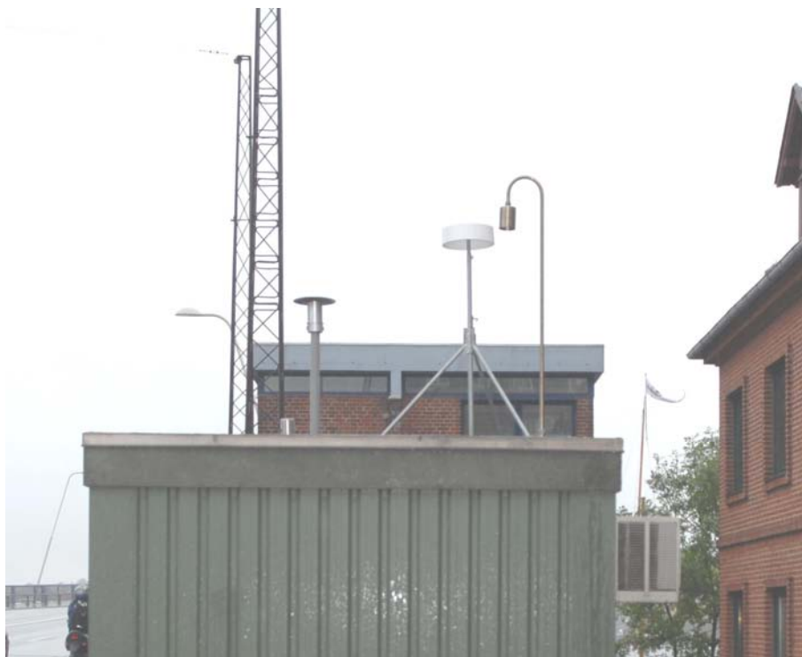
Figur 3.7. Stativ til montering af passive opsamlere (Radiellorør) til måling af luftens indhold af BTEX. Stativet er placeret på taget af målestationerne. Her vist for Vesterbro i Aalborg.
