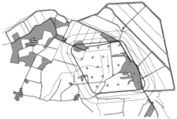
Figur 2. Placering af det oprindelige forslag til vindmøllepark samt de to alternative forslag. Vindmøllerne er vist sammen med udstrækningen af tre mulige forstyrrelseszoner, 300 m (benyttes for sangsvanernes vedkommende), 500 m (benyttes som alternativ forstyrrelseszone for de større 1,65 MW møller for sangsvanernes vedkommende) samt 800 m (mulig reaktionsafstand for flokke af hejle). Kortenes afgrænsning omfatter det i teksten omtalte nærområde idet markerne beliggende umiddelbart omkring Overgaard Gods ikke er inkluderet i dette. De grå områder angiver skovarealer.
