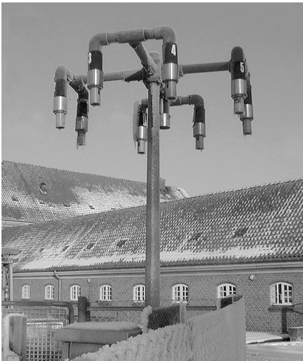
Figur 1.1 Eksempler på udstyr på målestationerne. Til venstre: Filterpackopsamler til opsamling af luftprøver. Filterpackopsamleren består af en filterholder (for enden af hver af de otte arme) indeholdende fire filtre, som luften suges igennem. Luftforureningskomponenterne opsamles derved på de fire filtre. Til højre: Nedbørsopsamlere til bestemmelse af bulkdeposition (dvs. våddeposition plus et lille bidrag fra tørdeposition). Nedbørsopsamlere består af et stativ, en tragt og en opsamlingsflaske skruet på forinden af tragten. Opsamlingsflasken er placeret i et rør for at beskytte mod solens lys.
