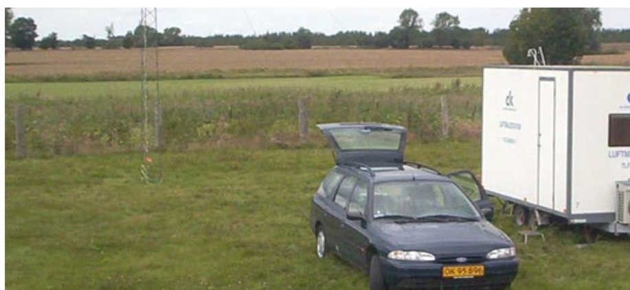
Figur 1.3 Målestation 1. Meteorologisk mast samt måleskur. Luftindtaget er på taget af måleskur i en højde af ca. 3 m.
