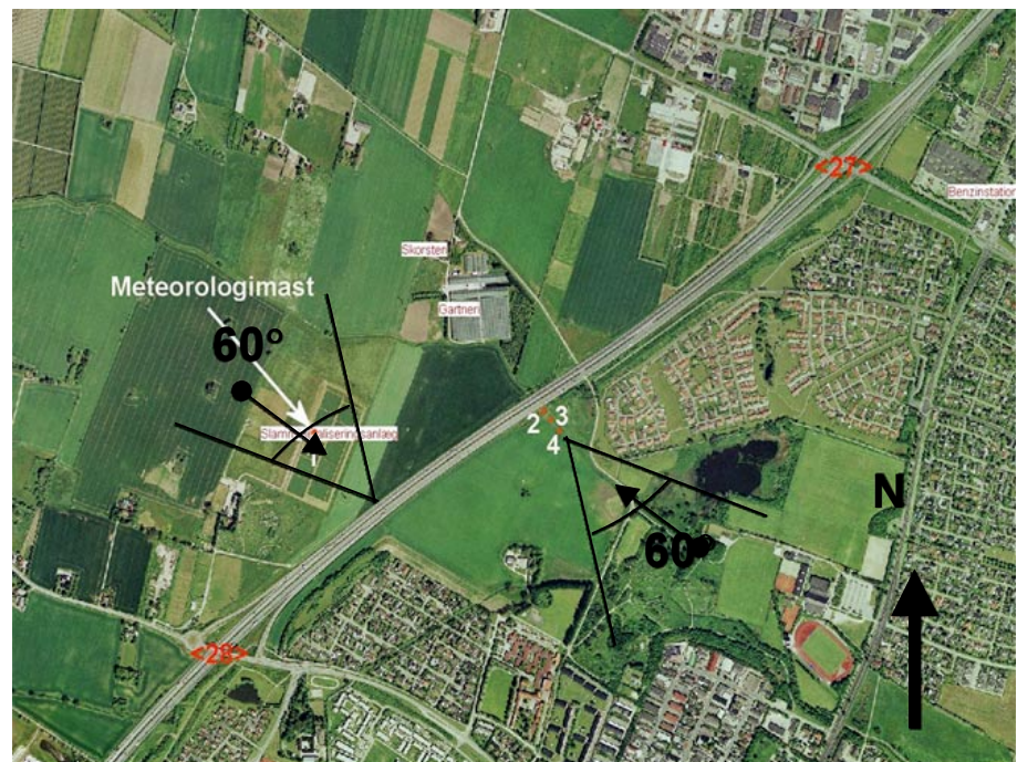
Figur 2.6 Vindretninger fra nordvest (320 grader plus/minus 30 grader) anvendes til at vurdere baggrundsbidraget af \text{NO}_x på station 1 og motorvejens maksimale bidrag til station 2-4 (1 m – 100 m). Vindretninger fra sydøst (135 grader plus/minus 30 grader) anvendes til at vurdere fortyndingen fra motorvejen til station 1, hvor afstanden er ca. 259 m.
