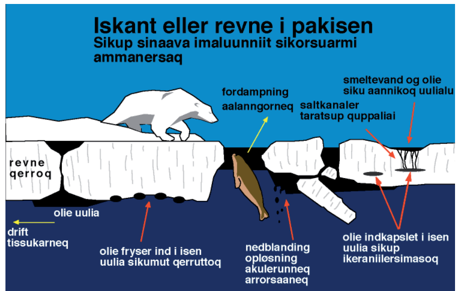
Figur 3. Eksempler på oliens opførsel i isdækket farvand. Oliens samles især i våger og sprækker og langs iskanter. Den kan ligge under isen og trænge op gennem revner og evt. samles oven på isen. Endelig kan olien fryse ind i isen og transporteres med denne. 23
