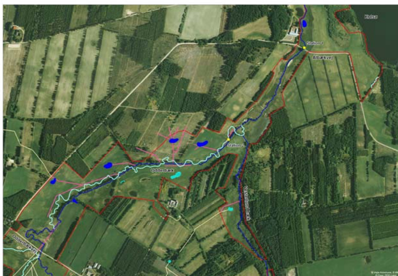
Figur 6.3. P-ådalsområdet ved Odderbæk mellem Odderbækvej og Ålbækvej. Dræn (pink) er omlagt til overrisling og damme (blå flader).
