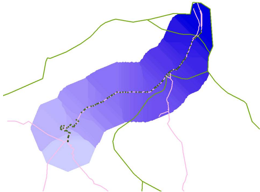
Figur 8.6. Cost allokering baseret på feltmålinger af koter. Man bemærker det jævne forløb af referenceniveaubåndet. Beregningen er begrænset til en afstand på 300 m fra hvert punkt. De feltmålte koter er markeret med grønne firkanter.
