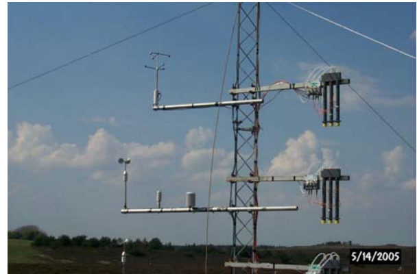
Figur 9.1. Foto af mast med meteorologiudstyr og denudere på Idom Hede. På billedet til højre ses to denuderholdere på højre side af masten. Modsat den øverste denuderholder ses sonic anemometer og under den en vindhastighedsmåler samt en temperatur og fugtighedsmåler
