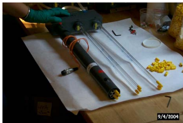
Figur 9.2. Denuderholder med 3 x 3 denudere, hvor sættet til venstre er forsynet med varmekappe.
