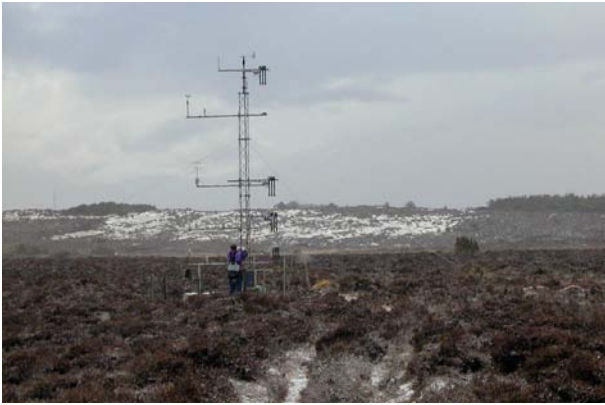
Figur 9.1. Foto af mast med meteorologiudstyr og denudere på Idom Hede. På billedet til højre ses to denuderholdere på højre side af masten. Modsat den øverste denuderholder ses sonic anemometer og under den en vindhastighedsmåler samt en temperatur og fugtighedsmåler
