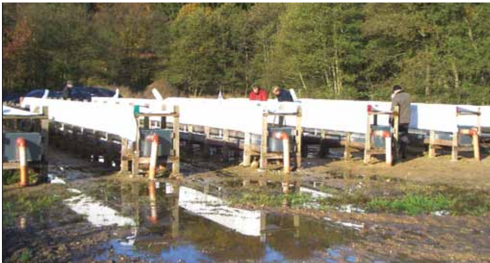
Figur 3-3 Forskere fra DMU i Silkeborg og Syddansk Universitet i Odense opstiller kunstige vandløb, strømrønder, som de bruger til forskellige analyser. Her kan forskerne tilsætte et insekticid til vandet og stille opsamlingsnet for enden af de kunstige vandløb. De efterfølgende timer opsamles og registreres de vandløbsdyr, der er havnet i nettet som konsekvens af katastrofedrift.
