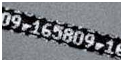
Figur 10.3 Hvert CW-mærke havde en kode, som kunne aflæses i stereolup. Foto: DTU Aqua
