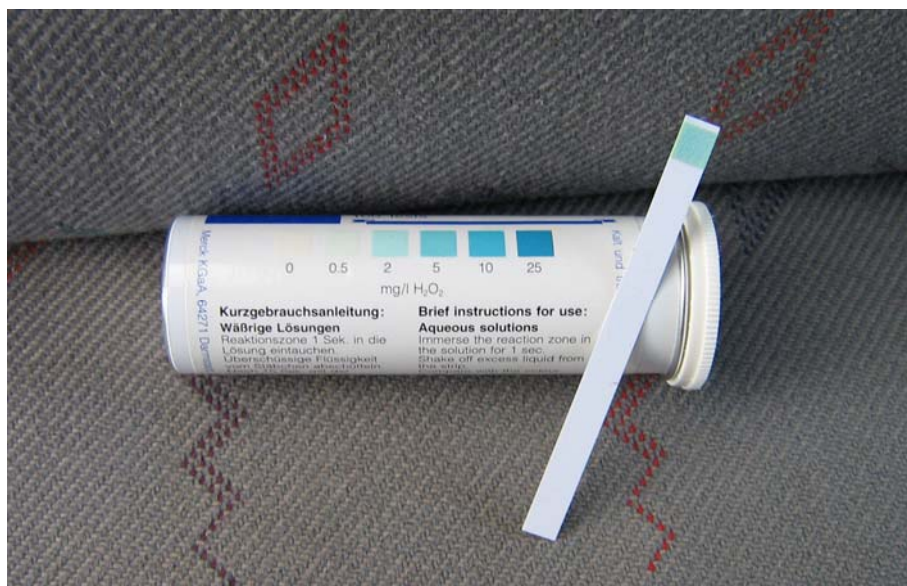
Figur 4.8 Sticks til måling af brintoverilte i en dam (Merckoquant 1.10011.0001 fra Merck). Sticksene dyppes i vandet, og efter 15 sekunder sammenlignes den udviklede farve med den på farveskalaen. Da farven fortsat udvikles, er det vigtigt at aflæse efter den angivne tid. Erfaringen har vist, at den koncentration, som sticksken angiver, er ca. 2 mg/l for lav.
