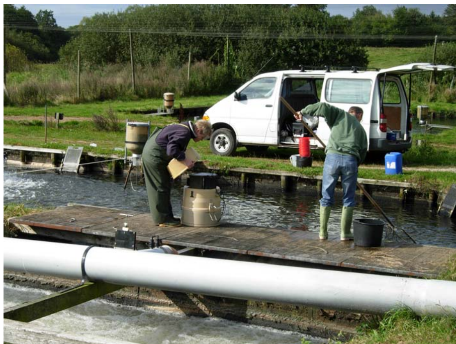
Figur 3.19 Opfiskning af døde fisk på risten i Silstrup dambrug. Mængden af døde fisk blev løbende vejret og registreret over flere dage. Laborantfuldmægtig Marlene Venø Skjærbæk checker den automatiske prøvetager, der tog prøver hvert 15. minut under behandlingen.
