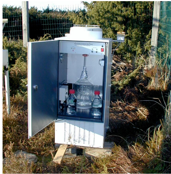
Figur 8.1 Wet-only sampler til opsamling af organiske miljøfremmede stoffer i regnvand. Det hvide låg dækker opsamlingstragten i tørre perioder. Når det regner drejes låget væk fra tragten som vist til venstre. Regnvandet opsamles i en 5 l glasflaske (den store flaske i midten), som opbevares koldt i prøvetagerens køleskab under opsamlingen. De to mindre flasker er blindprøver.
