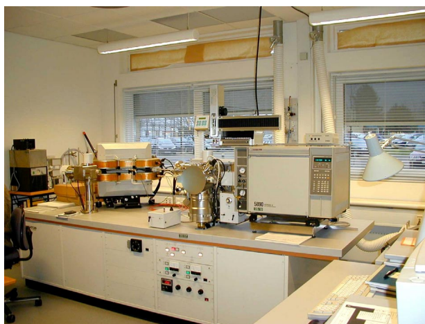
Figur 8.2 Gaskromatograf med højopløsende massespektrometer (Kratos), som anvendes til analyse af de chlorerede pesticider.
