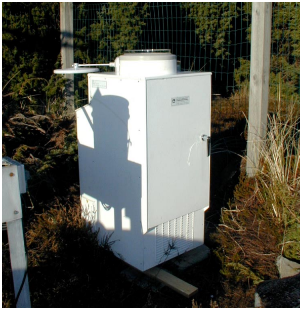
Figur 8.1 Wet-only sampler til opsamling af organiske miljøfremmede stoffer i regnvand. Det hvide låg dækker opsamlingstragten i tørre perioder. Når det regner drejes låget væk fra tragten som vist til venstre. Regnvandet opsamles i en 5 l glasflaske (den store flaske i midten), som opbevares koldt i prøvetagerens køleskab under opsamlingen. De to mindre flasker er blindprøver.
