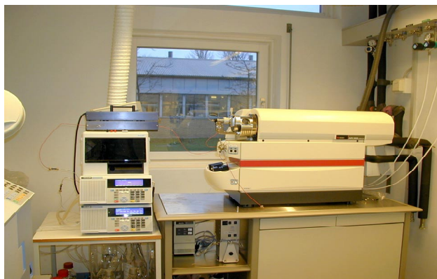
Figur 8.3 Billedet til venstre viser LC-MS-MS-instrument. (Perkin Elmer) som anvendes til analyse af polære (vandopløselige) pesticider og nitrophenoler Billedet til højre viser LC-MS-MS-kromatogram fra analyse af pesticider og nitrophenoler i regnvandsprøve.
