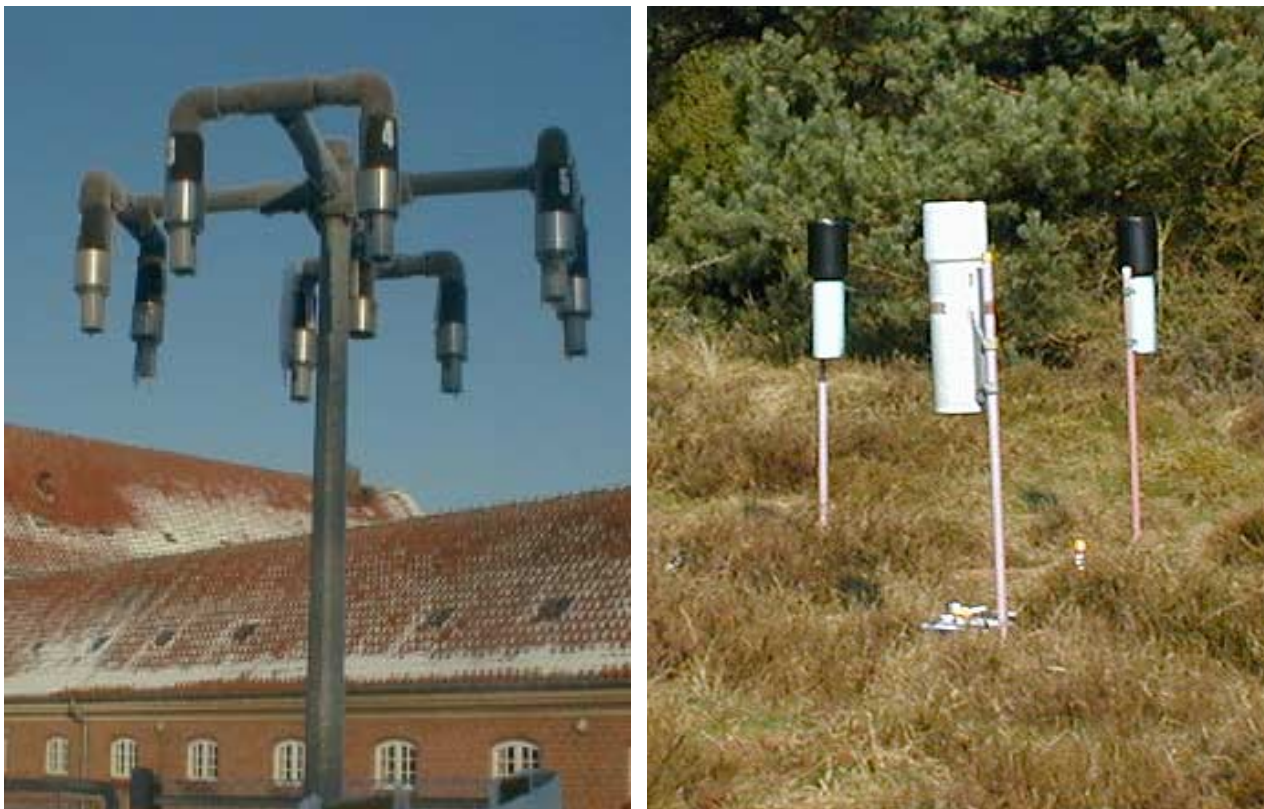
Figur 1.1 Eksempler på udstyr på målestationerne. Til venstre: Filterpackopsamler til opsamling af luftprøver. Opsamleren består af en filterholder (for enden af hver af de otte arme) med fire filtre, som luften suges igennem, hvorved partikler og gasser opsamles og separeres. Til højre: Nedbørsopsamlere til bestemmelse af bulkdeposition (dvs. våddeposition plus et lille bidrag fra tørdeposition). Nedbørsopsamlerne består af et stativ, en tragt og en opsamlingsflaske monteret for enden på tragten. Opsamlingsflasken er placeret i et rør for at beskytte mod solens lys.
