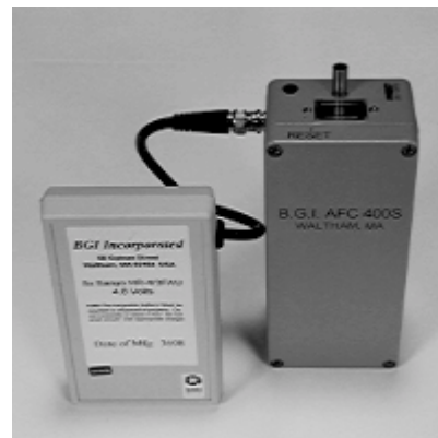
Figur 2.4 Udstyr til PM 2.5 målinger. Til venstre KTL cyklon fra BGI og til højre BGI400 pumpe (4 L/min, 0.6 kg) og batteri (24 eller 40 t 0,9 kg) fra BGI. Kilde: www.bgiusa.com . Reference: L.C. Kenny and R.A. Gussman, "Characterization and Modelling of a Family of Cyclone Aerosol Preseparators", J. Aerosol Sci. Vol. 28, No. 4, pp. 677-688, 1997, Pergamon Press.
