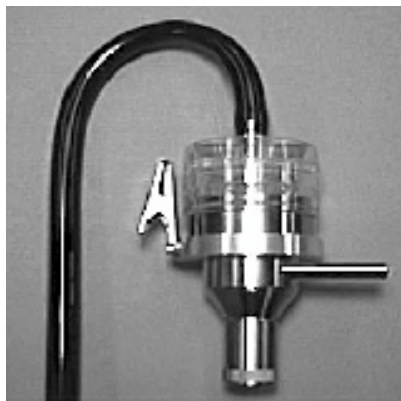
Figur 2.4 Udstyr til PM 2.5 målinger. Til venstre KTL cyklon fra BGI og til højre BGI400 pumpe (4 L/min, 0.6 kg) og batteri (24 eller 40 t 0,9 kg) fra BGI. Kilde: www.bgiusa.com . Reference: L.C. Kenny and R.A. Gussman, "Characterization and Modelling of a Family of Cyclone Aerosol Preseparators", J. Aerosol Sci. Vol. 28, No. 4, pp. 677-688, 1997, Pergamon Press.
