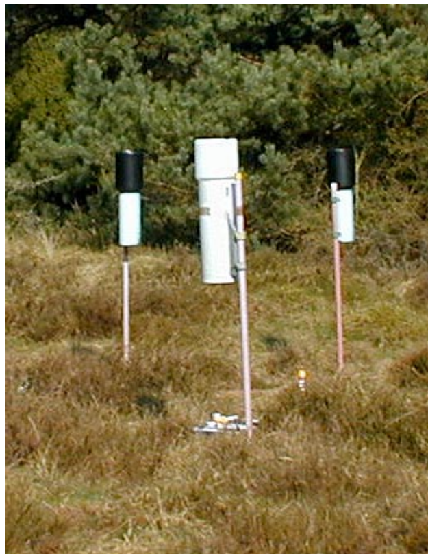
Figur 1.1 Eksempler på udstyr på målestationerne. Til venstre: Filterpackopsamler til opsamling af luftprøver. Opsamleren består af en filterholder (for enden af hver af de otte arme) med tre filtre, som luften suges igennem, hvorved partikler og gasser opsamles og separeres. Til højre: Nedbørsopsamlere til bestemmelse af bulkdeposition (dvs. våddeposition plus et lille bidrag fra tørdeposition). Nedbørsopsamlerne består af et stativ, en tragt og en opsamlingsflaske monteret forinden på tragten. Opsamlingsflasken er placeret i et rør for at beskytte mod solens lys.
