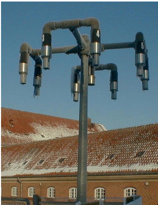
Figur 1.1 Eksempler på udstyr på målestationerne. Til venstre: Filterpackopsamler til opsamling af luftprøver. Opsamleren består af en filterholder (for enden af hver af de otte arme) med tre filtre, som luften suges igennem, hvorved partikler og gasser opsamles og separeres. Til højre: Nedbørsopsamlere til bestemmelse af bulkdeposition (dvs. våddeposition plus et lille bidrag fra tørdeposition). Nedbørsopsamlerne består af et stativ, en tragt og en opsamlingsflaske monteret forinden på tragten. Opsamlingsflasken er placeret i et rør for at beskytte mod solens lys.
