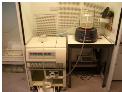
Figur 17.6 Sigteapparat koblet på gennemstrømningscentrifugen ved RIKZ i Holland.
