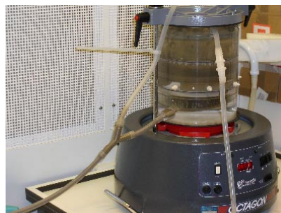
Figur 17.7 Sigtning i gang. Når slangerne er klare er sigtningen færdig og alt < 63 µm sediment opsamlet i centrifugen.
